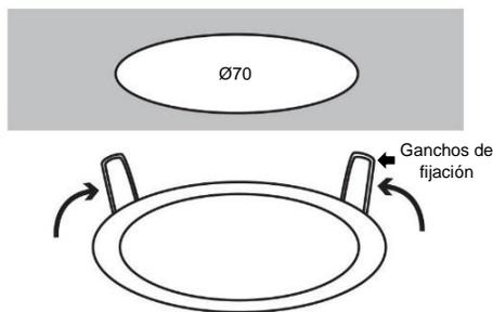
3. Soltar los ganchos una vez que se encuentre la luminaria dentro de la perforación del techo. Asegurarse que la luminaria quede ajustada en el techo.
