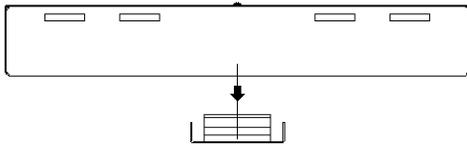
2. Al separar el divisor del chasis de la LUCCA-A, en el interior se encuentran 2 perforaciones de las cuales se realiza la sujeción en el cielo con el chazo, tornillo o cuelga, dependiendo del montaje.
