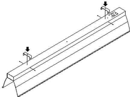
2. Asegurar la luminaria a los sujetadores con 4 tornillos ubicados en los laterales.
