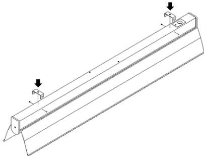
2. Asegurar la luminaria a los sujetadores con 4 tornillos ubicados en los laterales.
