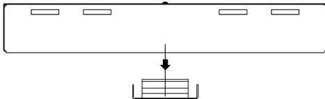
2. Al separar el divisor del chasis de la LUCCA, en el interior se encuentran 2 perforaciones de las cuales se realiza la sujeción en el cielo con el chazo, tornillo o cuelga, dependiendo del montaje.
