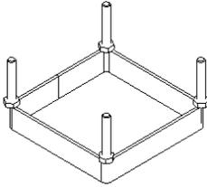
2. Tener en cuenta que al realizar el vaciado en concreto se debe dejar expuesto una parte de los pernos para poder asegurar el poste. (Mínimo 1”).
