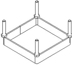
2. Tener en cuenta que al realizar el vaciado en concreto se debe dejar expuesta una parte de los pernos para poder asegurar el poste. (Mínimo 1”).
