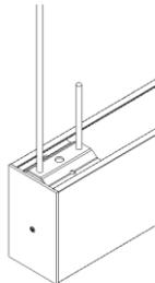
6. Una vez deslizada la luminaria, se debe asegurar la tapa retirada en el paso 1 y verificar la correcta instalación de la SINAI.
